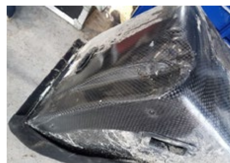
Fig. 4 - Exemple de dommage sur la coque
