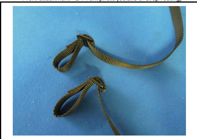
A3) Attache avant - photo 3/4 avant (détail de l'enroulement) Front attachment - 3/4 front photo (details of strap routing)
