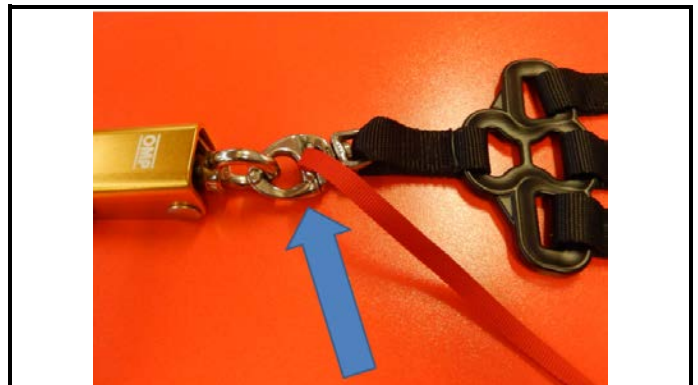
A4) Attaches arrière - photo 3/4 avant (détail de l'enroulement) Rear attachments - 3/4 front photo (details of strap routing)
