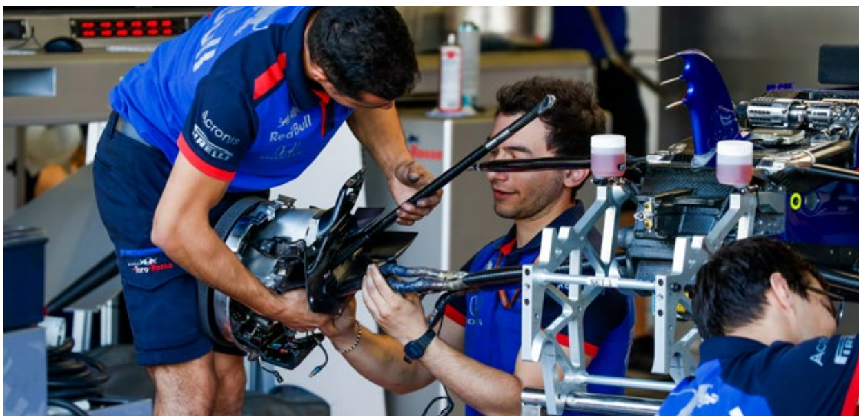
Figure 2 - Installation dans les triangles de suspension
