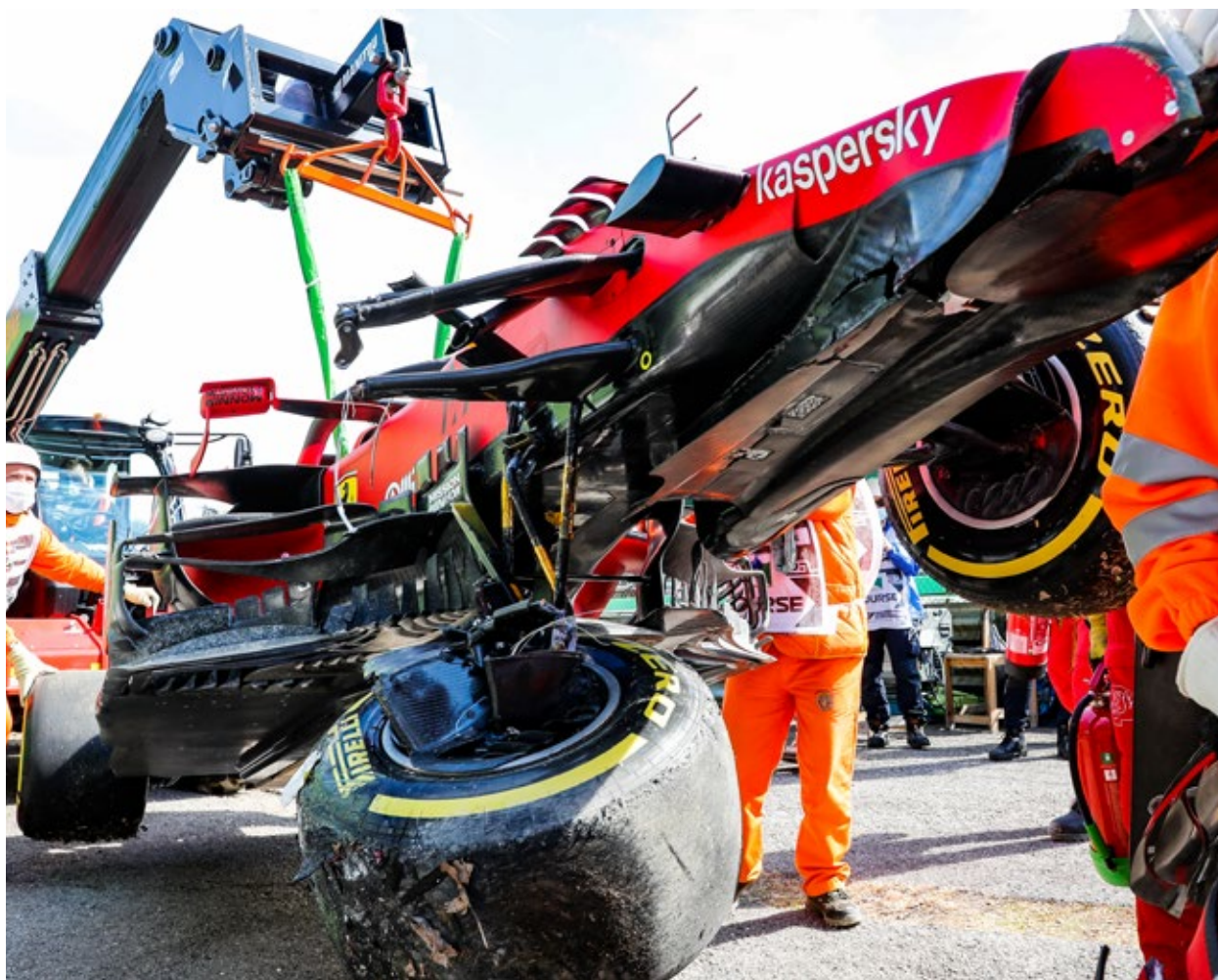
Figure 1 - Câbles de retenue retenant l'assemblage de roue
