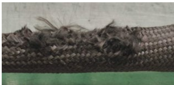
Figure 9 - Gaine endommagée du câble de retenue
