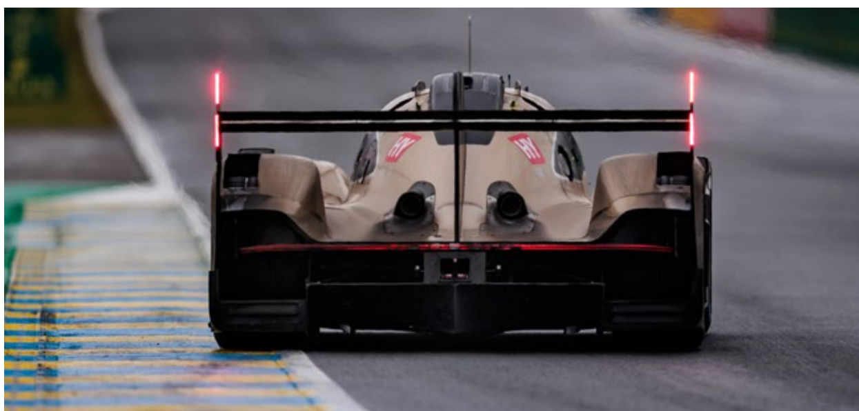
Figure 5 - Configuration verticale des feux de pluie
