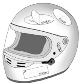
Figure 6 – Autocollants recouvrant des fissures sur la coque
