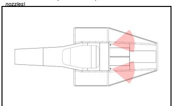
C1-4) Installation alternative dans les pontons (emplacement et orientation des buses)
