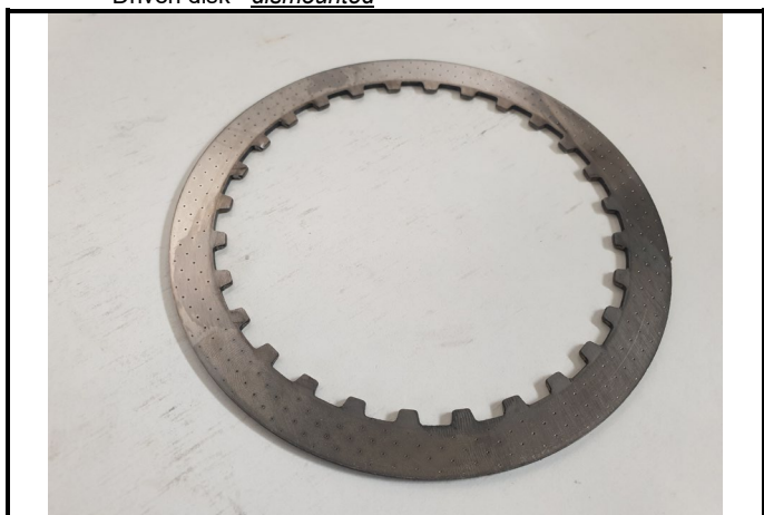
C17-3) Disque mené - déposé Driven disk - dismounted
