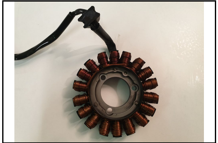
C15-2) Stator - déposé Stator - dismounted
