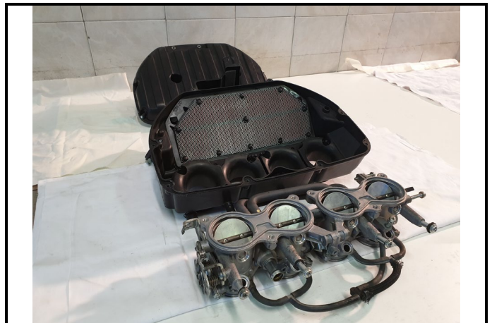
C11-4) Boitier papillon - déposé Throttle unit - dismounted
