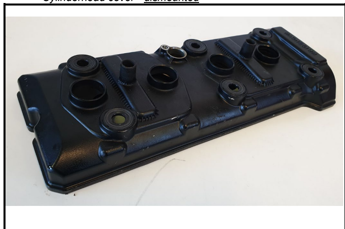
C1-3) Couvre culasse - déposé Cylinderhead cover - dismounted
