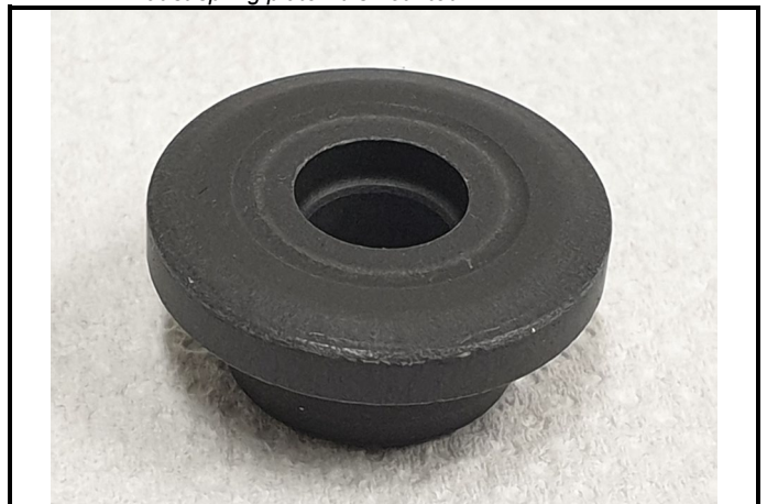
C12-2) Coupelle de ressort échappement - déposée Exhaust spring plate - dismantled
