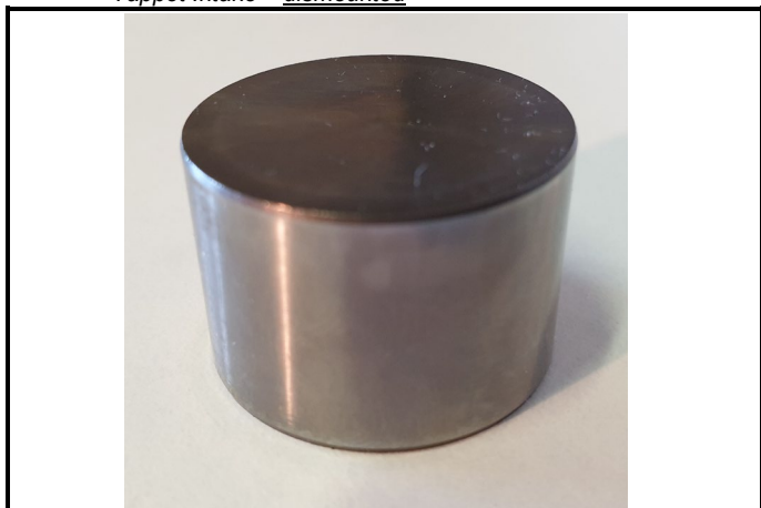
C10-6) Poussoir Admission - démonté Tappet Intake - dismounted
