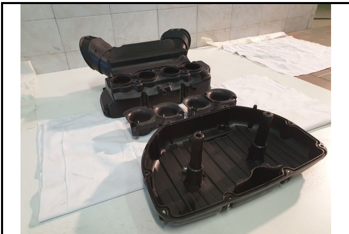
C11-3) Boitier papillon - déposé Throttle unit - dismounted
