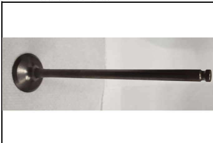
C12-1) Soupape échappement - déposée Exhaust valve - dismantled
