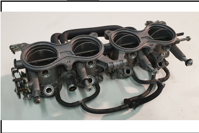
C11-3) Boitier papillon - déposé Throttle unit - dismounted
