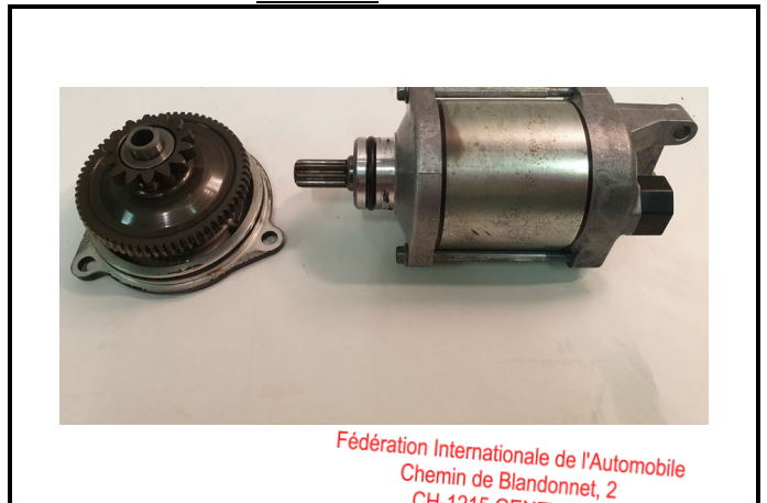
C16-2) Roue libre - déposée Free Wheel - dismounted
