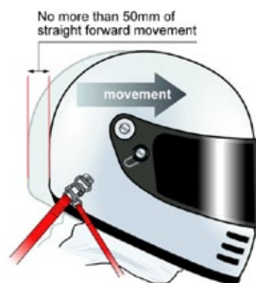
Figure 9 - Mouvement permettant de définir l'ajustement de la sangle
