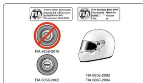
Figure 27 - Ancrages M6 8858-2002 – ne peuvent être utilisés qu'avec les casques 8858-2002 approuvés par la FIA (Liste Technique n° 41 – Partie 2)
