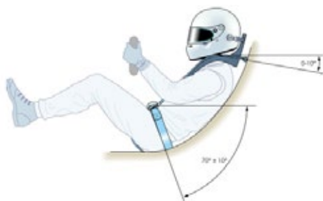
Figure 22 - Angle recommandé pour les sangles dans les voitures à habitacle ouvert
