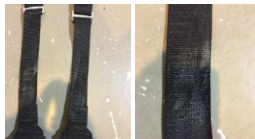
Figure 31 - Sangles d'épaule distendues après une collision grave
