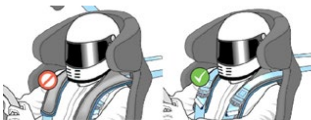
Figure 16 - Exemple de positionnement incorrect et correct des sangles du harnais lors de l'utilisation d'un HANS®
