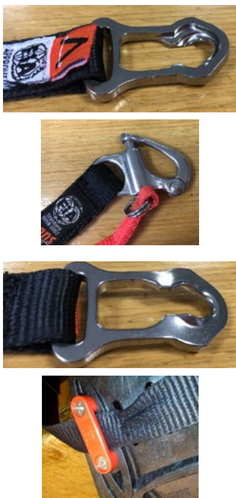
Figure 29 - Clip d'extrémité déformé (en haut à droite et à gauche, et en bas à gauche), et sangle RFT distendue (en bas à droite)
