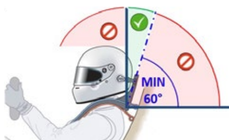
Figure 2 - Angle du col correct pour le dispositif HANS®
