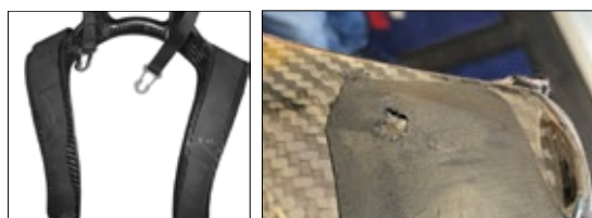
Figure 30 - Signes d'usure sur la surface en caoutchouc
