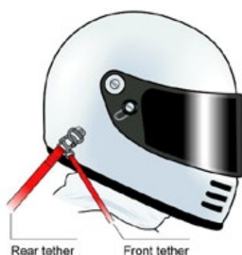
Figure 8 - Identification des sangles du dispositif Hybrid
