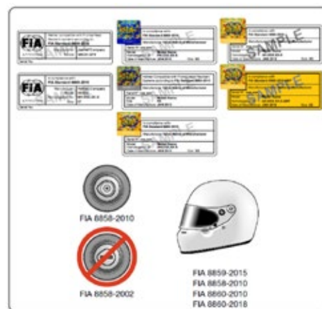
Figure 28 - Ancrage M6 8858-2010 - peut être utilisé avec les casques 8858-2010, 8859-2015, 8860-2010 et 8860-2018 approuvés par la FIA (Listes Techniques n° 41-Partie 1, 33, 49 et 69)
