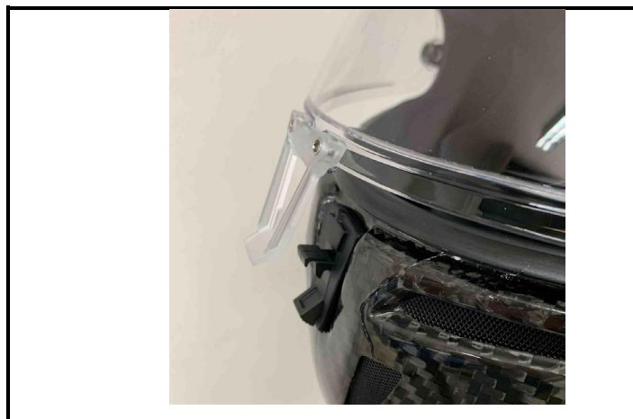
D2) Vue du mécanisme de verrouillage en position de visière ouverte / View of the locking mechanism in open visor position
