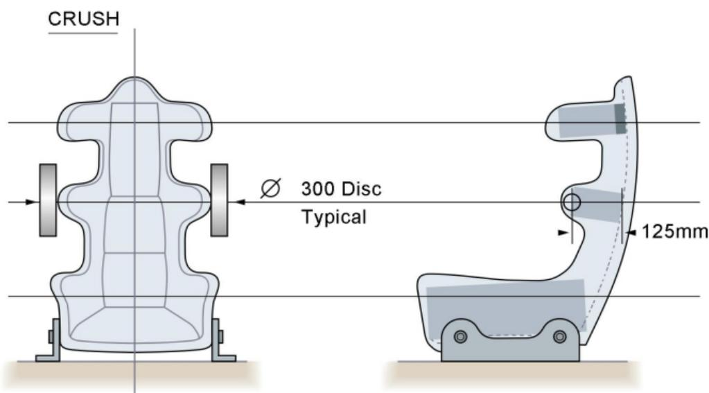
Figure D1. Configuration d'essai pour essai d'écrasement
