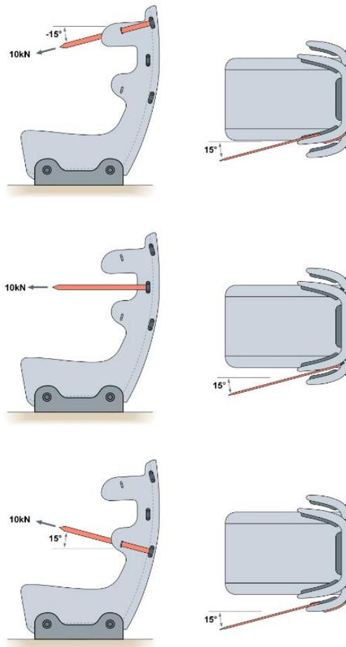
**Figure F2. Angles du Tableau F1 à prendre en compte pour l'application des charges**
