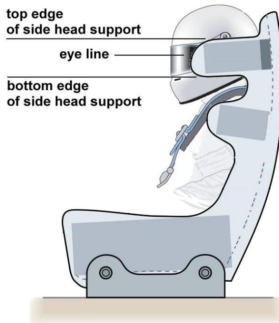
Figure 32. Position recommandée pour la tête des pilotes par rapport au support latéral de la tête
