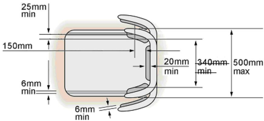
Figure A3. Dimensions pour le Côté du siège-tête et les matériaux absorbant l'énergie
