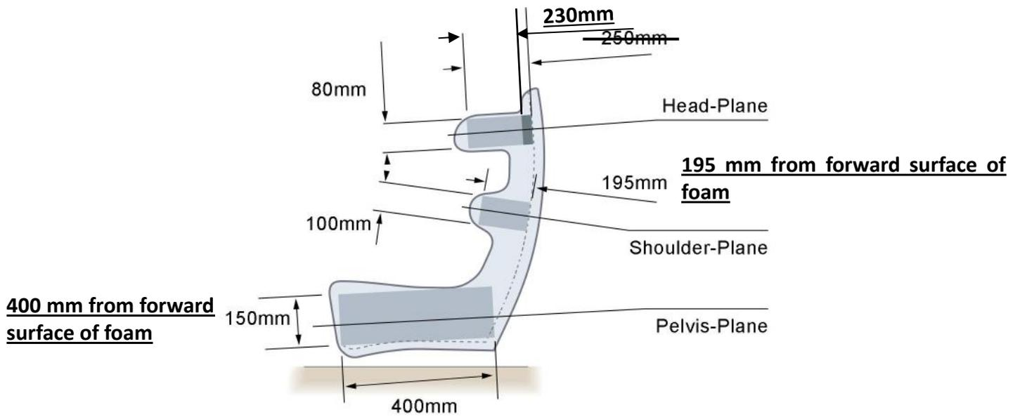
Figure A2. Plans de référence (pour la tête, les épaules et le bassin) et dimensions MINIMALES
