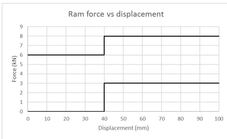
**Figure 1 Corridor du déplacement pour l'essai des supports du siège pour rallye**
