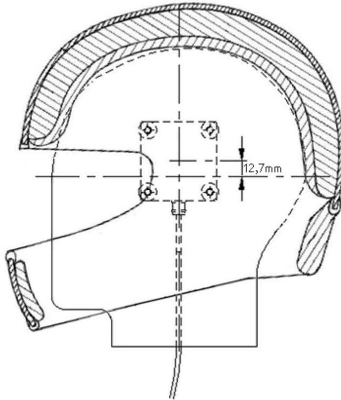
**Figure C4. Vue latérale de l'emplacement du capteur de force par rapport au plan de référence**
