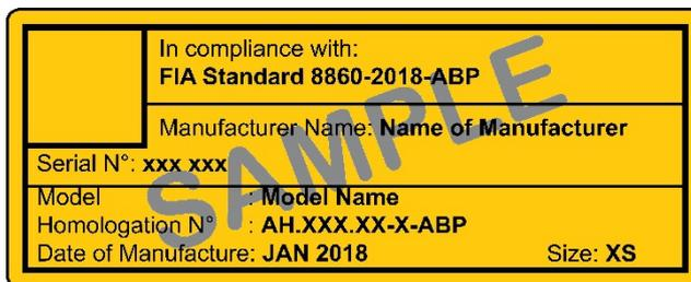
Figure 4.a Etiquette d'homologation FIA spécifique pour les casques avec Protection balistique avancée intégrée
