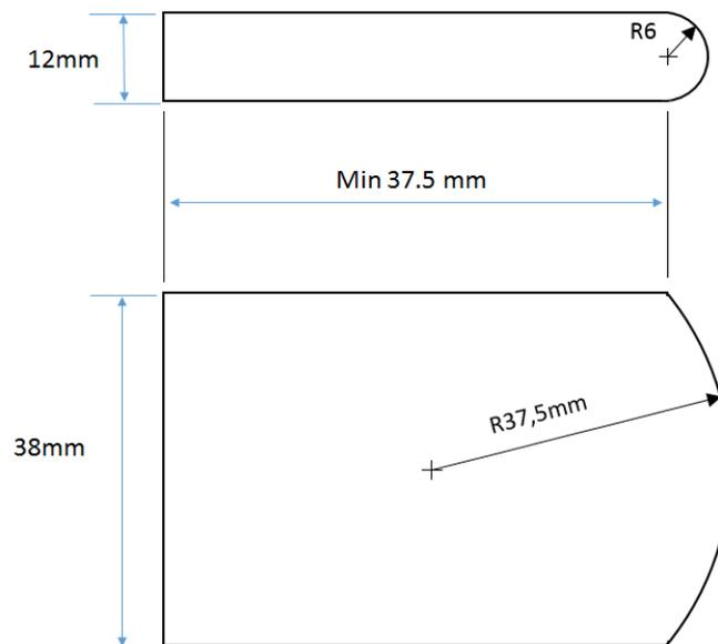
Figure B2 – Projectile pour essai balistique
