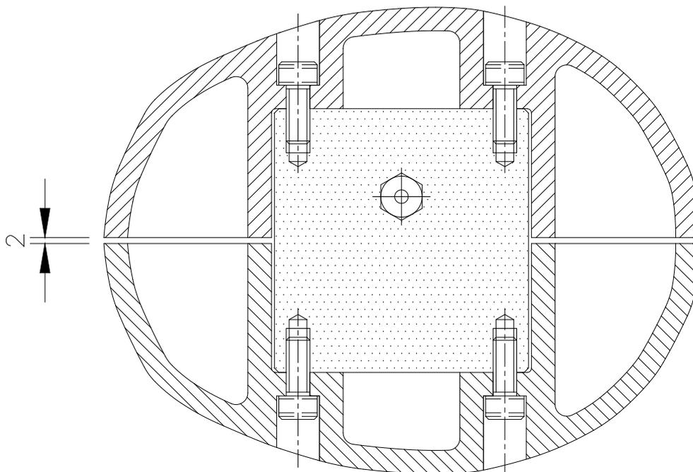
**Figure C3. Plan de coupe de la fausse tête et du capteur**
