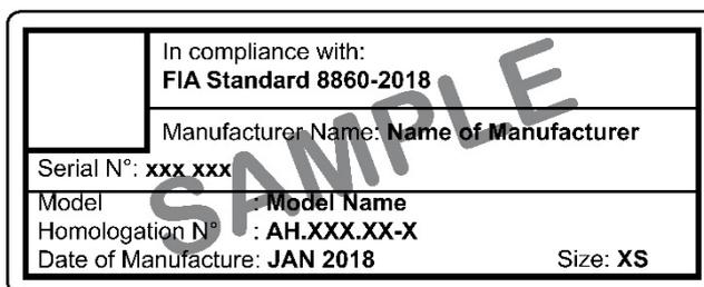
Figure 4.b Etiquette d'homologation FIA spécifique pour les casques sans Protection balistique avancée intégrée
