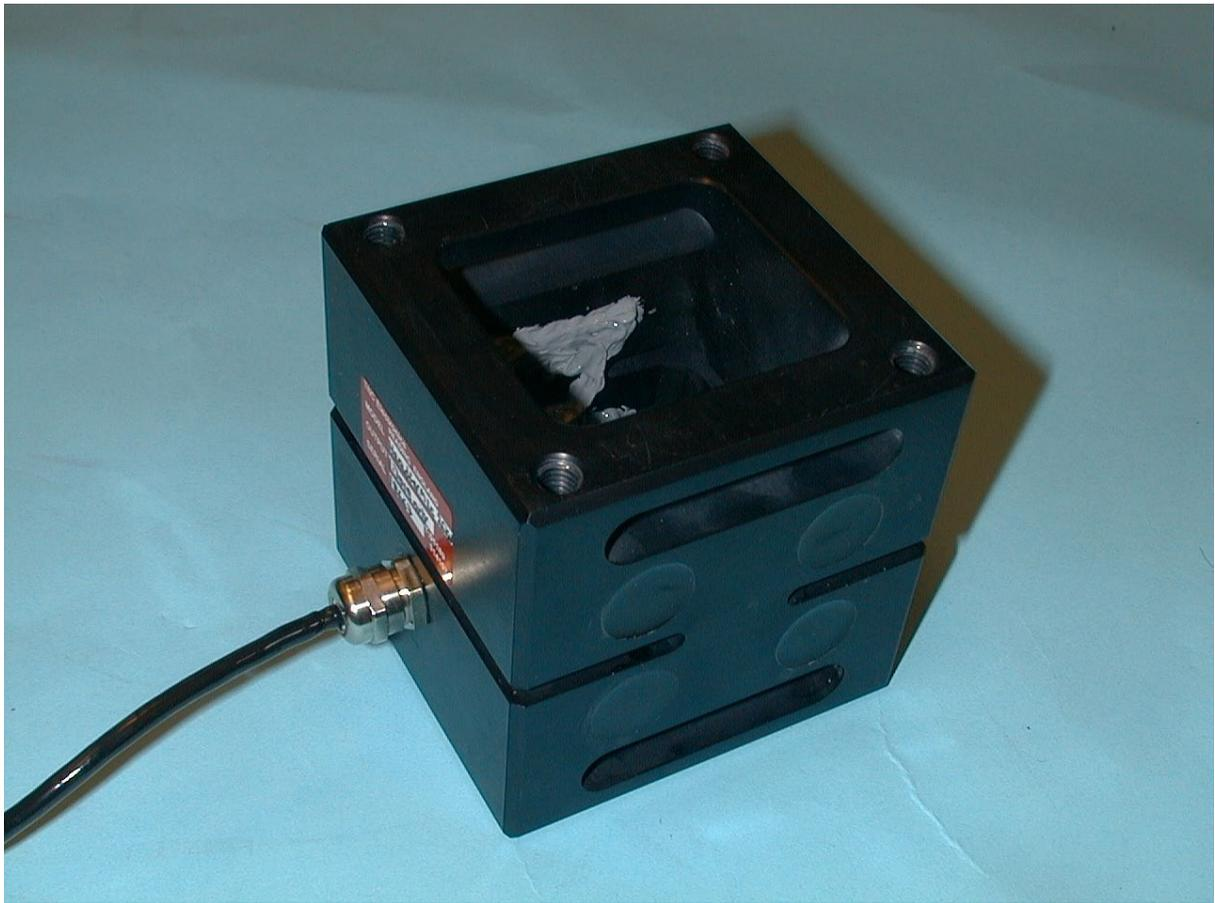
**Figure C2. Photographie du capteur de force**
