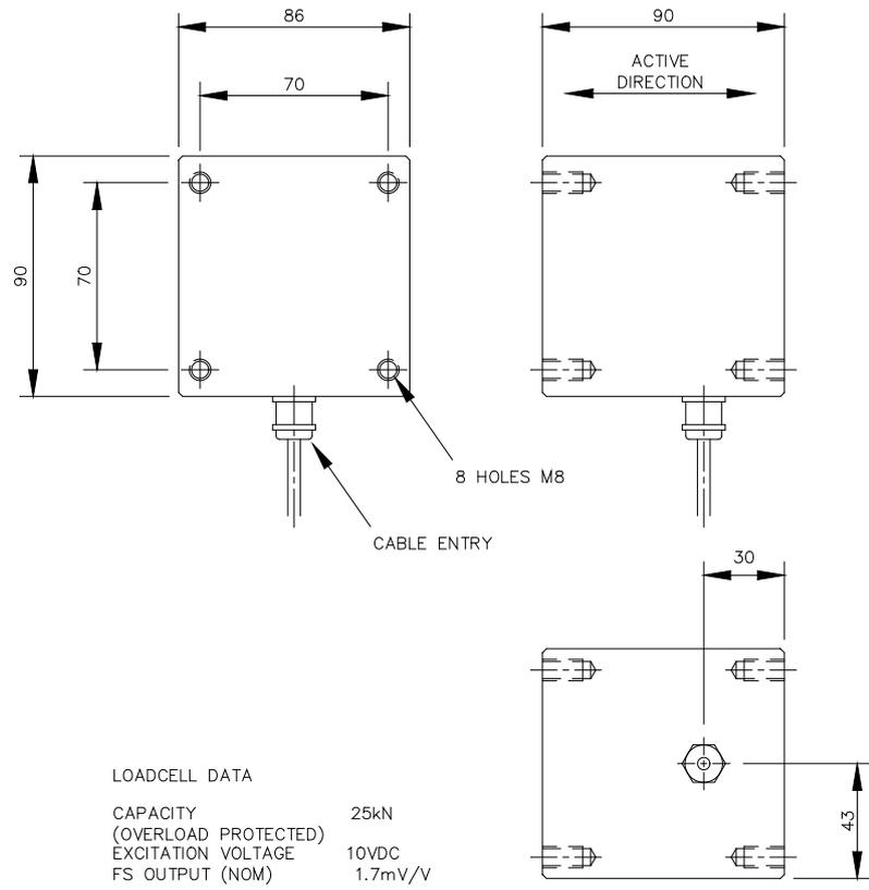
**Figure C1. Schéma du capteur de force**
