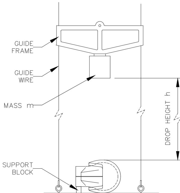
**Figure C5. Appareillage adapté à l'essai d'écrasement**
