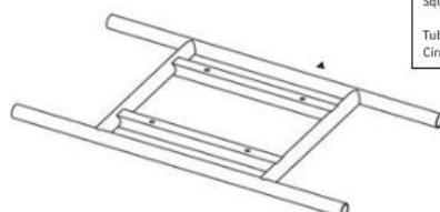
**Construction "D"****3.9.3.1 Entretoises transversales pour l'ancrage du siège**
