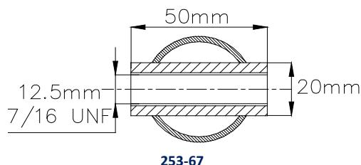
Ces inserts doivent être disposés dans le renfort et les sangles doivent y être fixées par des boulons M12 8.8 ou 7/16 UNF.
