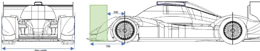
**16.4.5 Porte-à-faux du diffuseur à Y200****Diffuser overhang at Y200**
