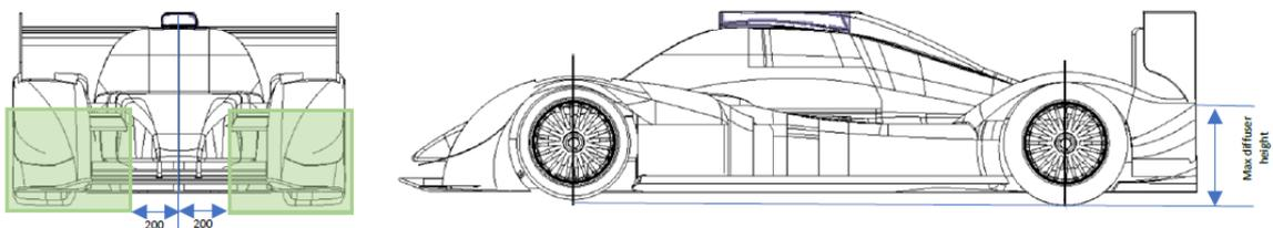
**16.4.13 Type de plancher avant (Plancher ou Aile avant)****Front Floor Type (Floor or Front Wing)**
