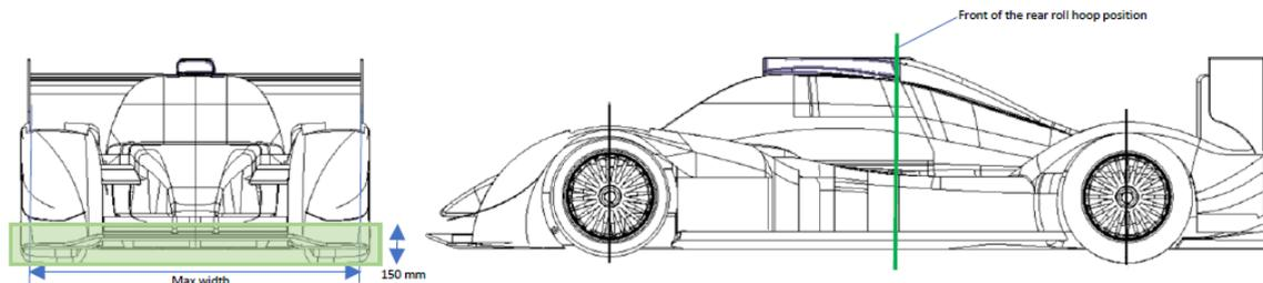
**16.4.12 Hauteur statique à l'arrière du diffuseur****Static height at rear of diffuser**
