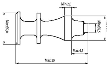
Des pneus cloutés peuvent être utilisés pendant l'épreuve. Ils doivent être conformes à la réglementation ci-après :
