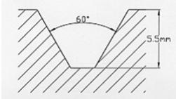
**2.5** Dans la zone de contrôle, la surface occupée par des rainures d'au moins 1,8 mm de profondeur, d'une section d'au plus 60° de dépouille (schéma) et 2 mm de largeur, doit occuper au moins 21,5 % de la surface totale.
