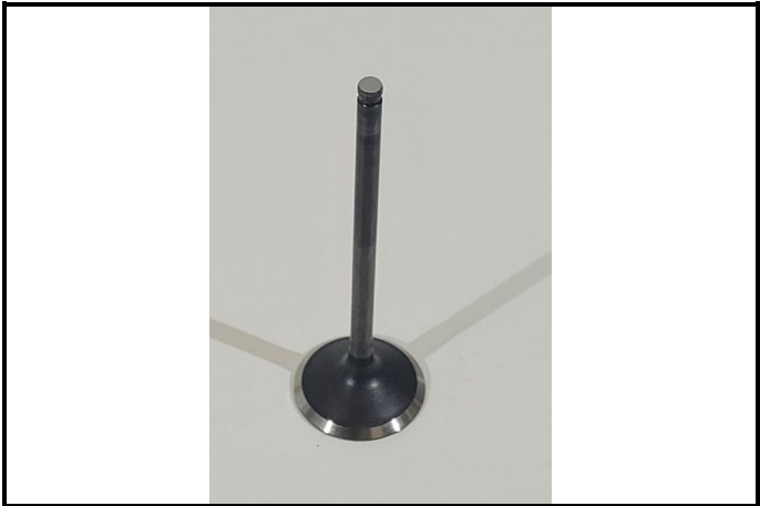
C12-1) Soupape échappement - déposée Exhaust valve - dismantled
