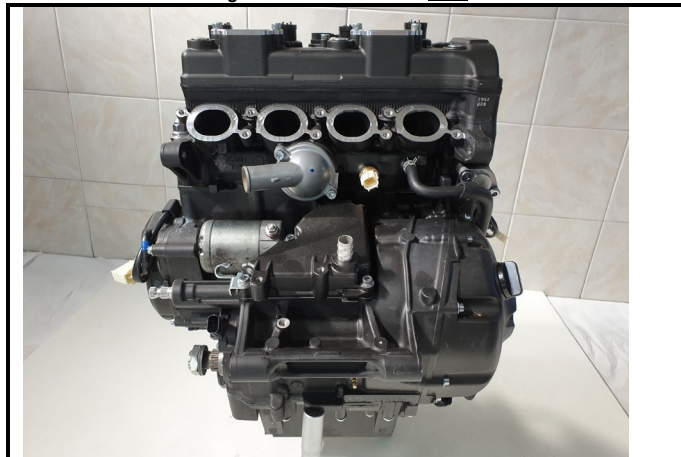
C1-4) Couvre culasse - déposé Cylinderhead cover - dismounted
