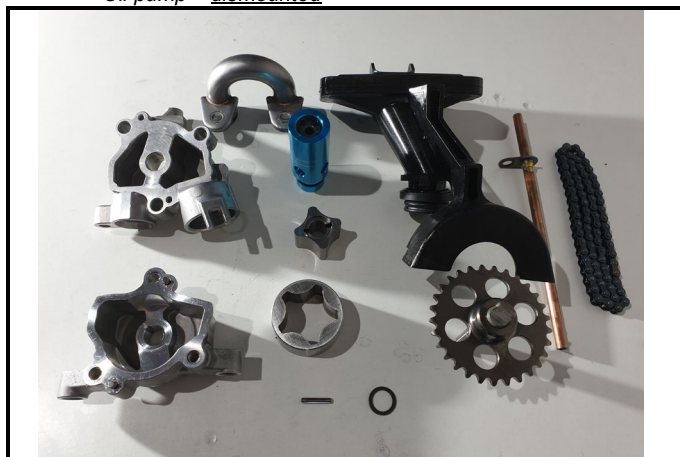
C14-3b) Pompe à huile - déposée Oil pump - dismounted
