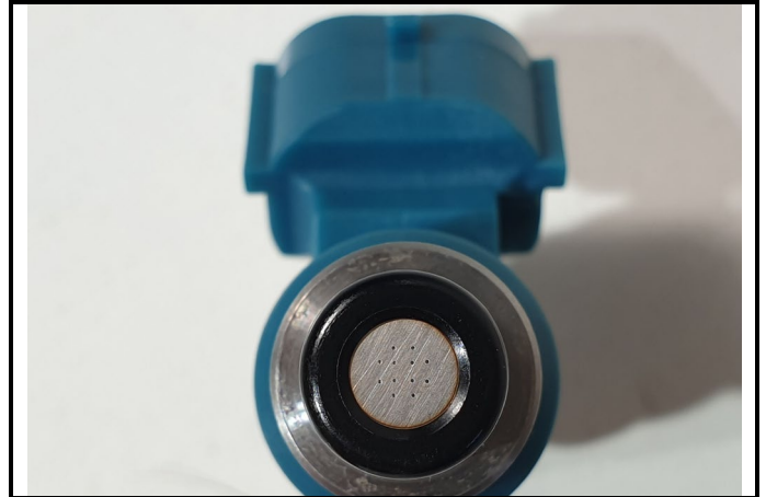
C9-2) Nozzle Injecteurs haut High Injectors Nozzle
