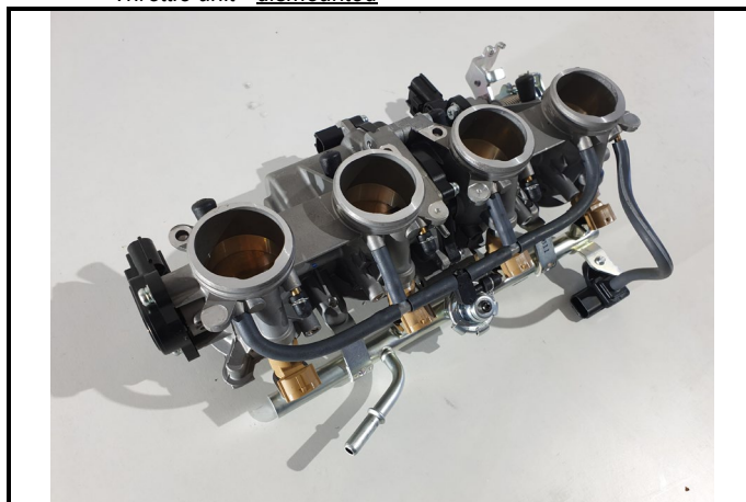
C11-4) Boitier papillon - déposé Throttle unit - dismounted
