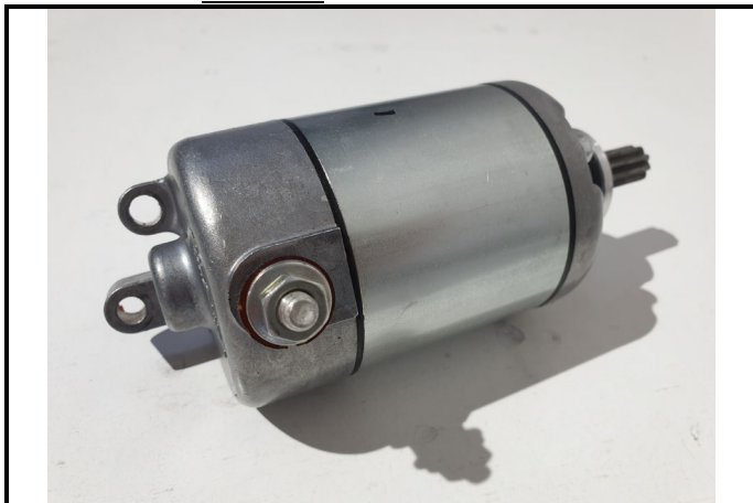
C16-1) Démarreur - déposé Starter - dismounted
