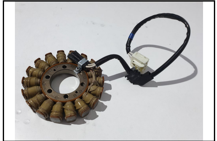
C15-2) Stator - déposé Stator - dismounted
