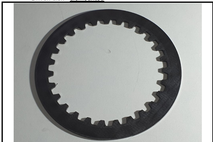
C17-3) Disque mené - déposé Driven disk - dismounted
