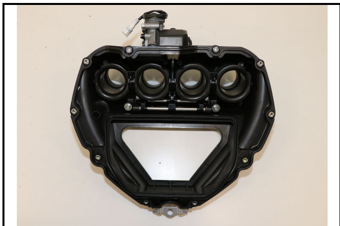
C11-3) Boitier papillon - déposé Throttle unit - dismounted
