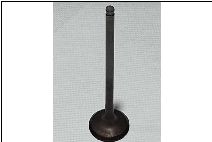
C12-1) Soupape échappement - déposée Exhaust valve - dismantled
