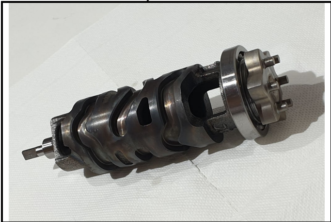
F9-5) Assemblage du barillet Selector barrel assembly
