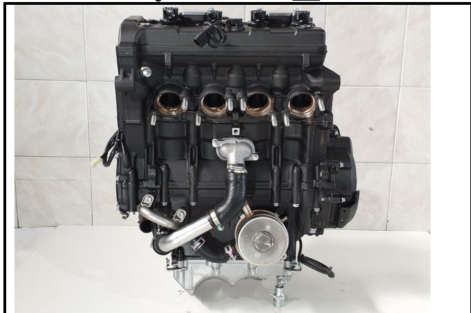
C1-3) Couvre culasse - déposé Cylinderhead cover - dismounted
