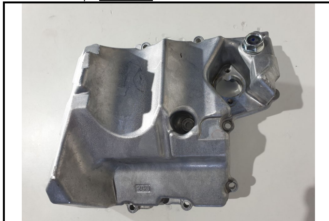
C14-3b) Pompe à huile - déposée Oil pump - dismounted
