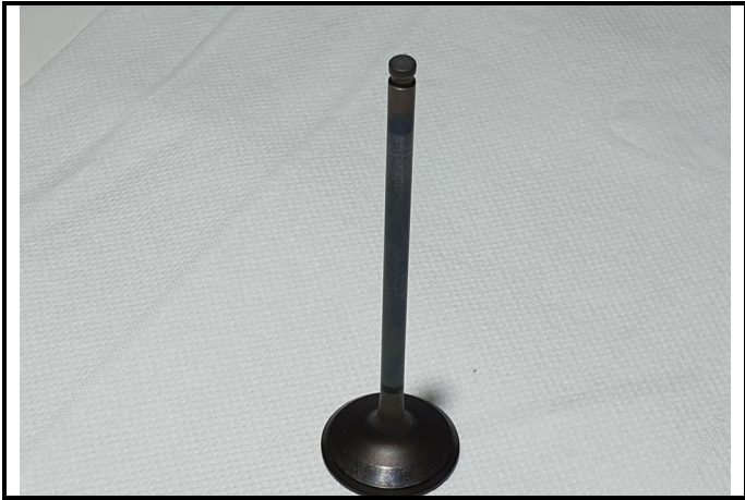
C11-5) Soupape admission - déposée Intake valve - dismantled
