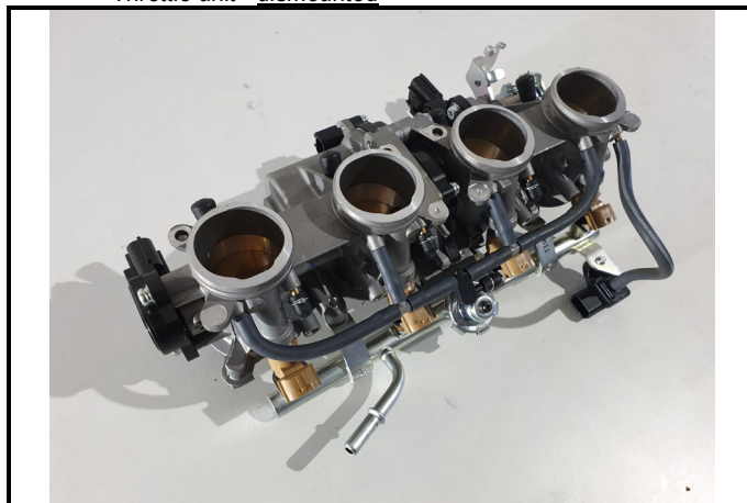
C11-4) Boitier papillon - déposé Throttle unit - dismantled
