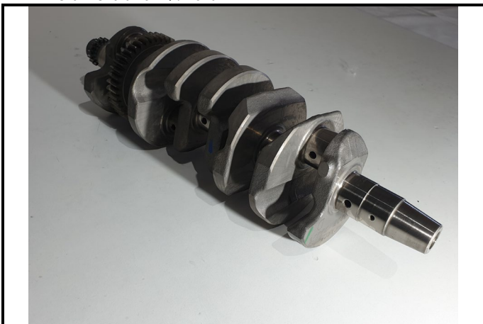
C6-1) Vilebrequin de ¾ avant Crankshaft from ¾ front
