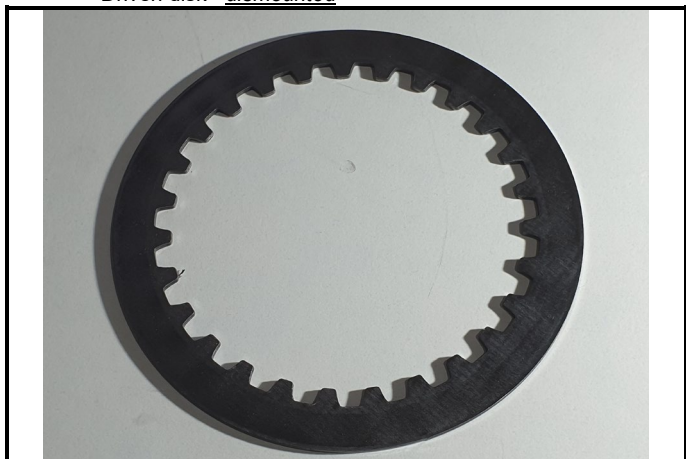
C17-3) Disque mené - déposé Driven disk - dismounted
