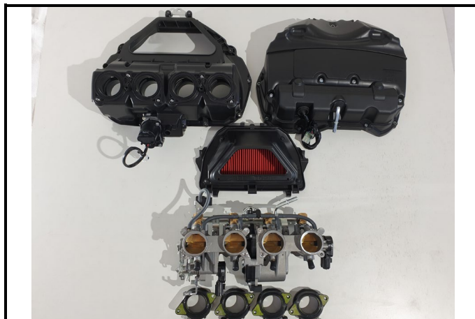
C11-4) Boitier papillon - déposé Throttle unit - dismantled
