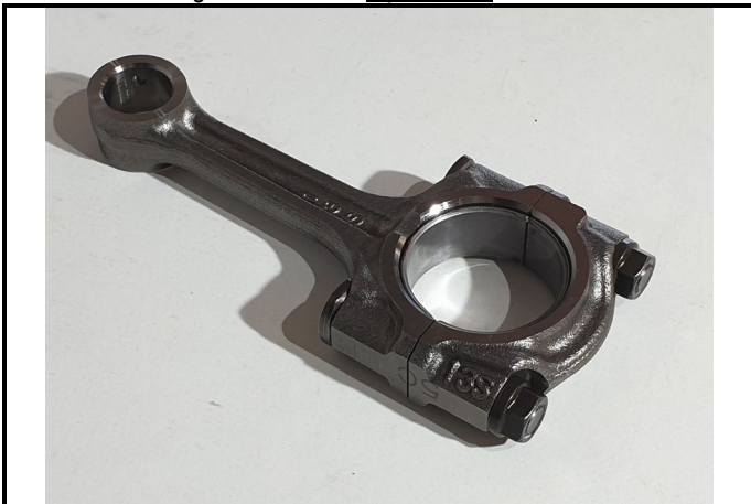
C5-1) Bielle de ¾ côté tête Connecting rod from ¾ on big end side
