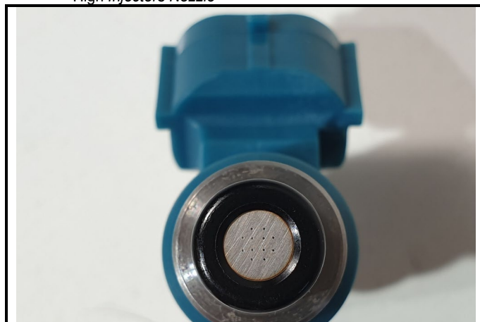
C9-2) Nozzle Injecteurs haut High Injectors Nozzle
