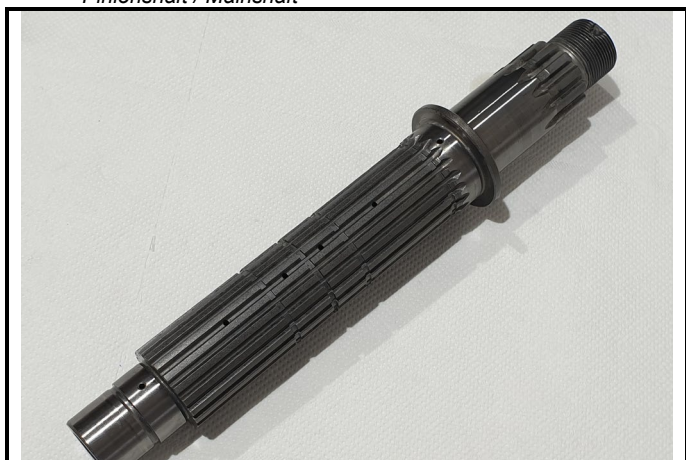
F8-1) Arbre secondaire Pinionshaft / Mainshaft
