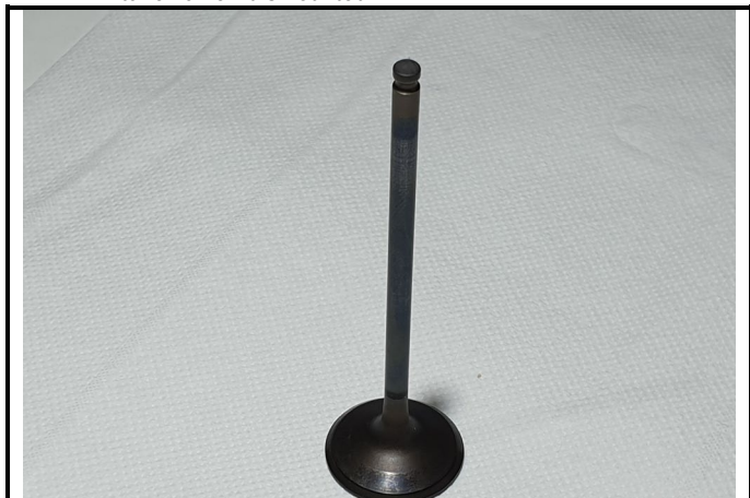
C11-5) Soupape admission - déposée Intake valve - dismantled
