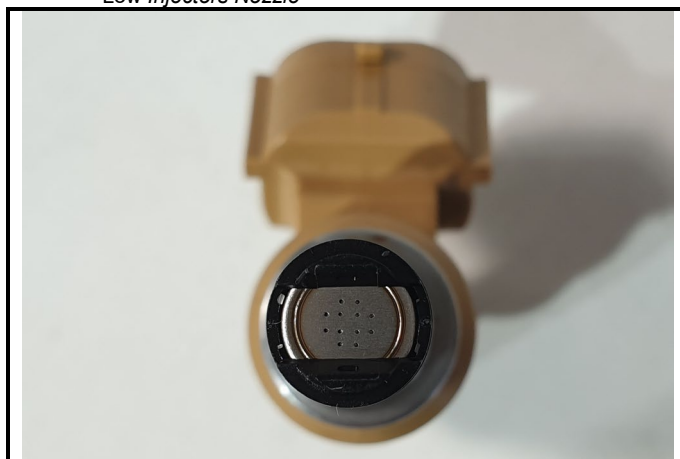
C9-2) Nozzle Injecteurs bas Low Injectors Nozzle
