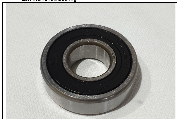
F8-2) Roulement gauche de l'arbre secondaire Left mainshaft bearing
