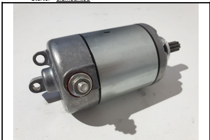
C16-1) Démarreur - déposé Starter - dismounted
