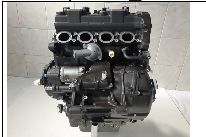
C1-4) Couvre culasse - déposé Cylinderhead cover - dismounted
