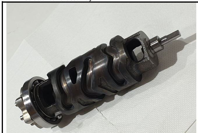
F9-5) Assemblage du barillet Selector barrel assembly
