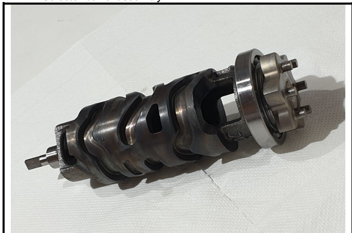
F9-5) Assemblage du barillet Selector barrel assembly
