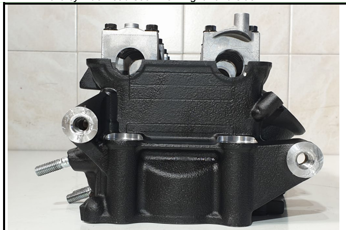
C8-6) Culasse nue vue côté droit Bare cylinderhead seen from right hand side
