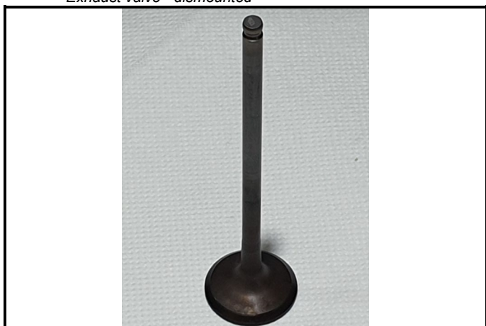
C12-1) Soupape échappement - déposée Exhaust valve - dismantled
