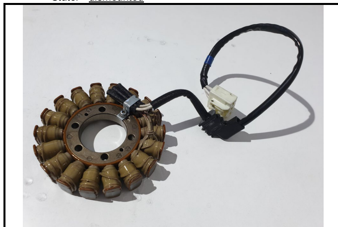
C15-2) Stator - déposé Stator - dismounted
