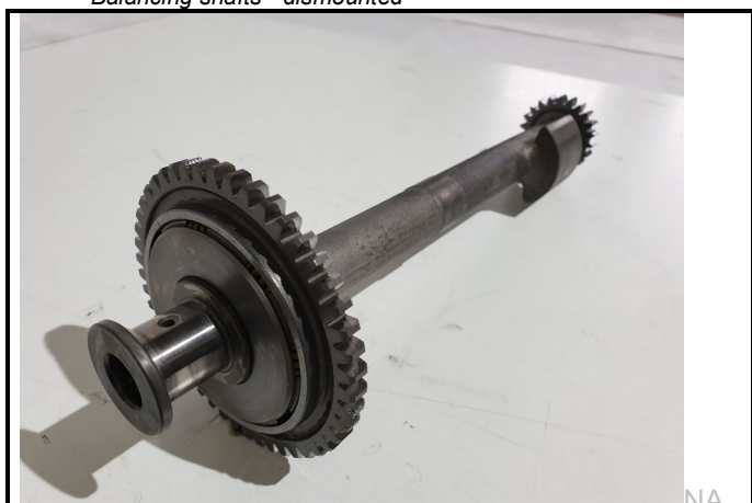
C3-9) Arbres d'équilibrage - démontés Balancing shafts - dismantled
