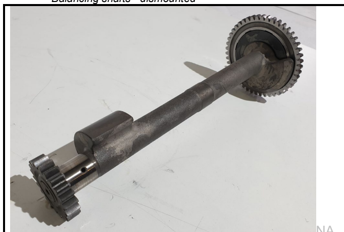
C3-10) Arbres d'équilibrage - démontés Balancing shafts - dismantled
