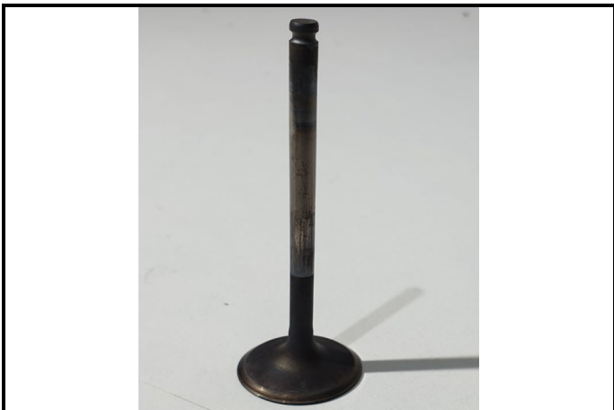
C12-1) Soupape échappement - déposée Exhaust valve - dismantled
