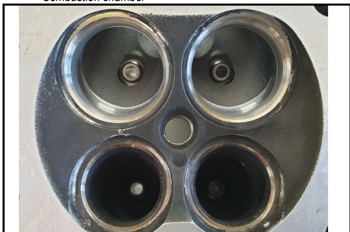
III-E1) Diamètre maximum au niveau du siège admission Maximum intake seat diameter
