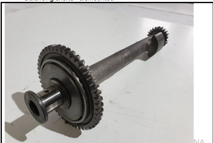
C3-9) Arbres d'équilibrage - démontés Balancing shafts - dismantled
