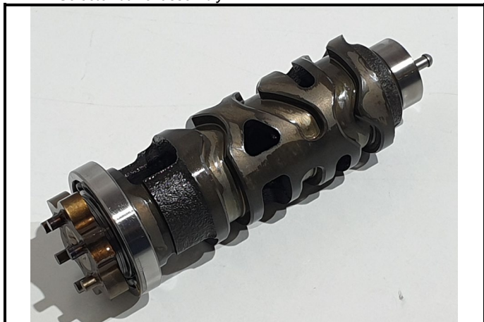
F9-5) Assemblage du barillet Selector barrel assembly
