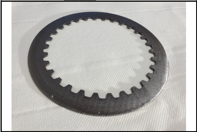
C17-3) Disque mené - déposé Driven disk - dismounted
