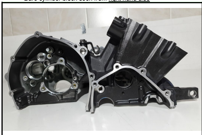
C3-5) Bloc-cylindre nu vu côté Echappement
