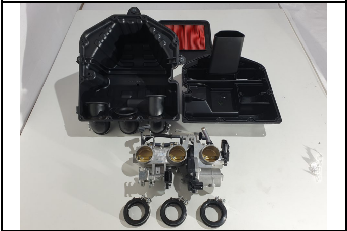
C11-3) Boitier papillon - déposé Throttle unit - dismounted
