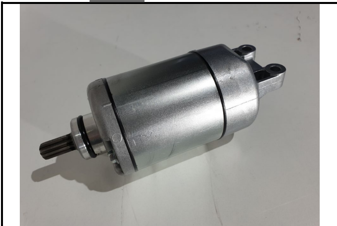
C16-1) Démarreur - déposé Starter - dismounted
