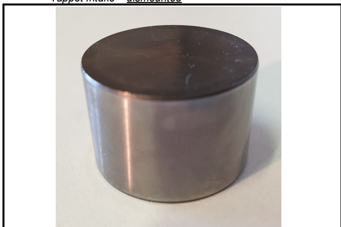
C10-6) Poussoir Admission - démonté Tappet Intake - dismounted
