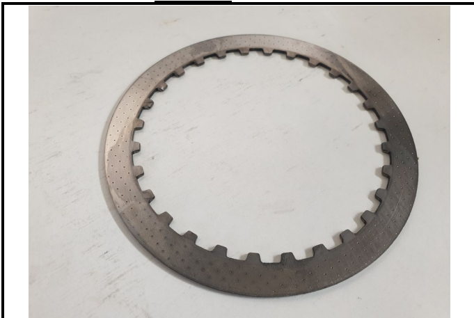
C17-3) Disque mené - déposé Driven disk - dismounted
