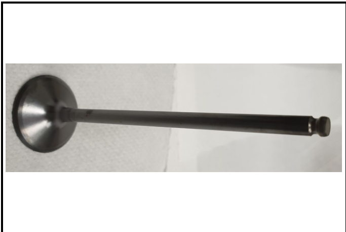
C11-5) Soupape admission - déposée Intake valve - dismantled
