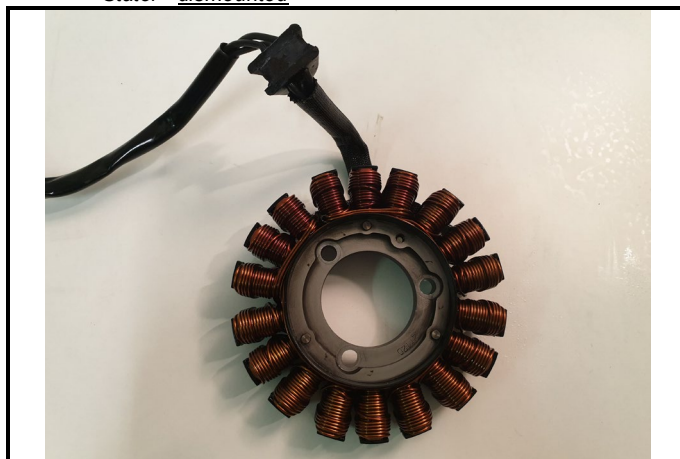
C15-2) Stator - déposé Stator - dismounted
