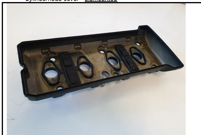
C1-4) Couvre culasse - déposé Cylinderhead cover - dismounted
