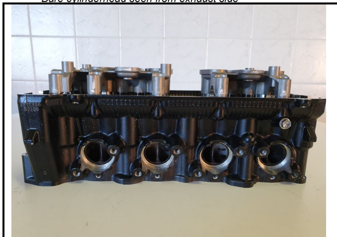
C8-4) Culasse nue vue côté échappement Bare cylinderhead seen from exhaust side
