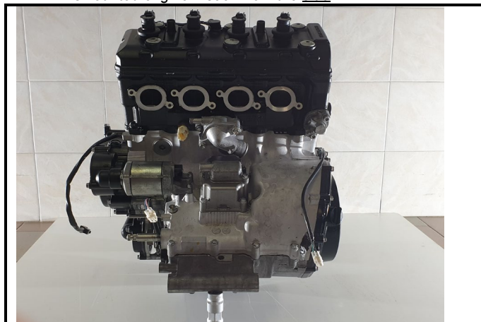
C1-4) Couvre culasse - déposé Cylinderhead cover - dismounted
