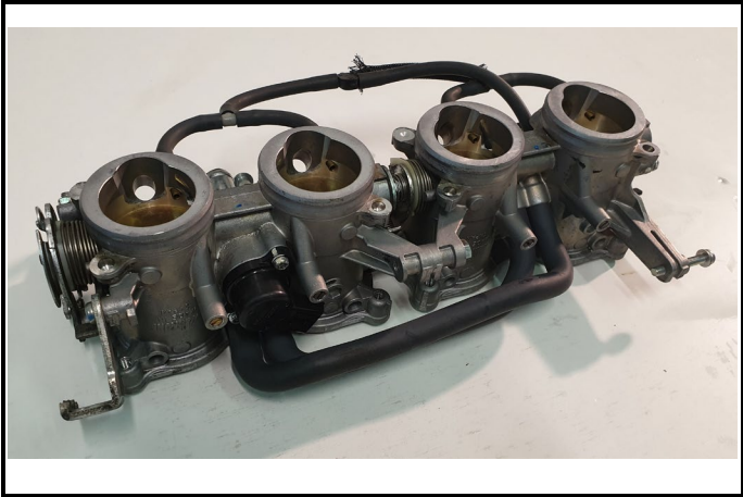
C11-4) Boitier papillon - déposé Throttle unit - dismounted
