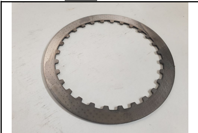
C17-3) Disque mené - déposé Driven disk - dismounted
