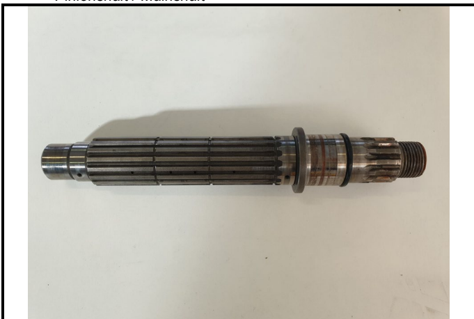
F8-1) Arbre secondaire Pinionshaft / Mainshaft
