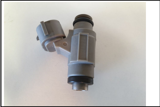
C9-1) Injecteurs haut High Injectors
