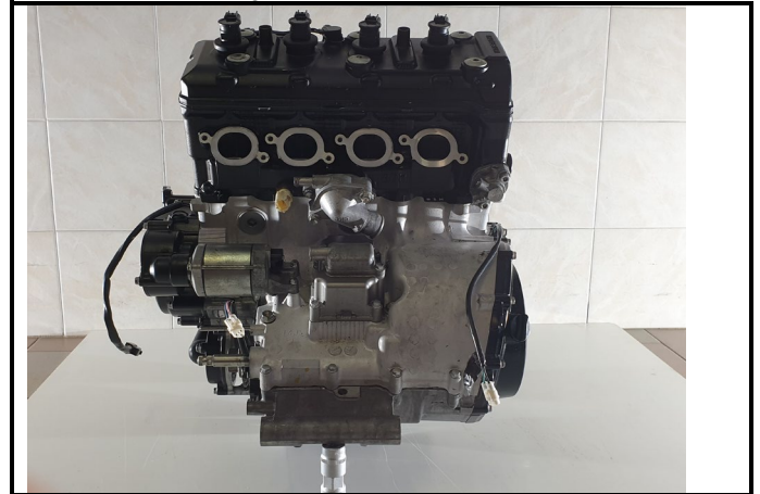
C1-4) Couvre culasse - déposé Cylinderhead cover - dismounted
