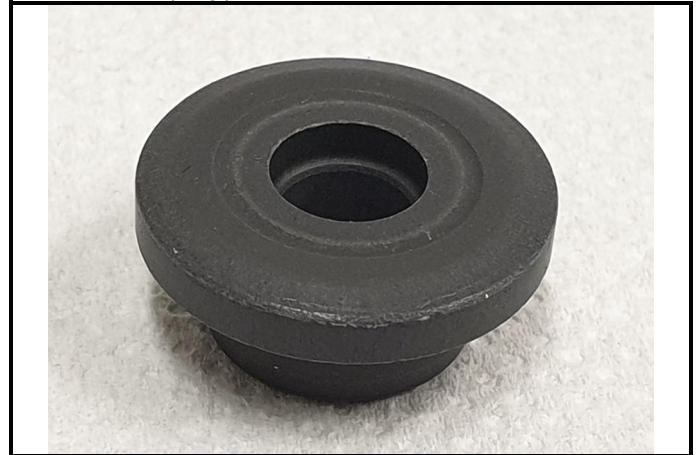
C11-6) Coupelle de ressort admission - déposée Intake spring plate - dismantled
