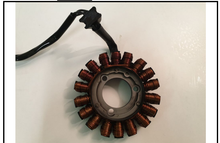
C15-2) Stator - déposé Stator - dismounted
