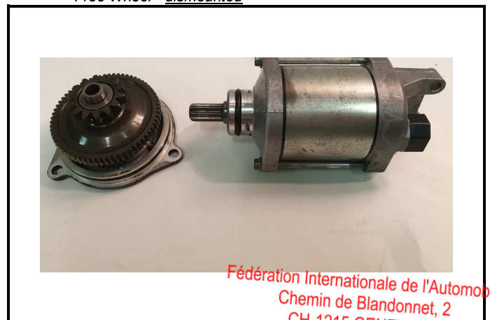
C16-2) Roue libre - déposée Free Wheel - dismounted
