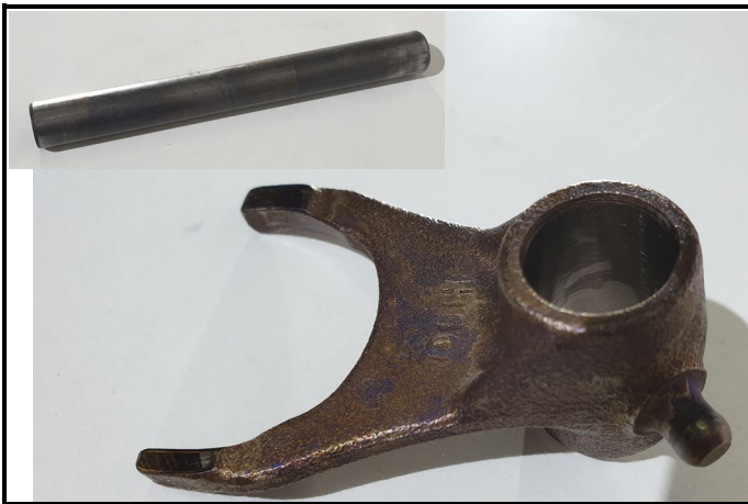
F9-1) Fourchette n°1 et axe : Selector forks n°1 and axle:
