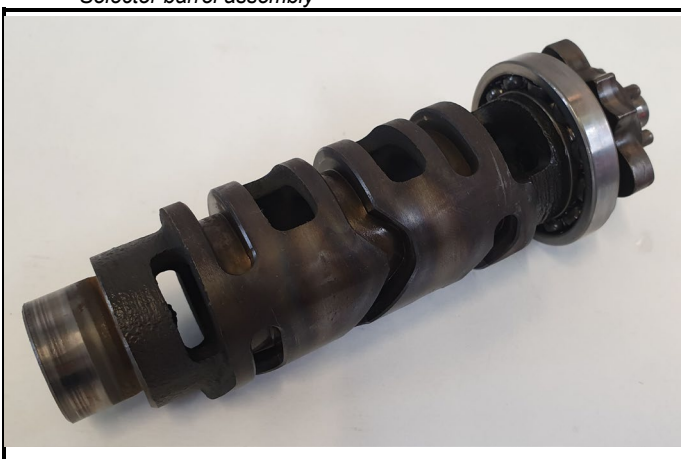
F9-4) Assemblage du barillet Selector barrel assembly
