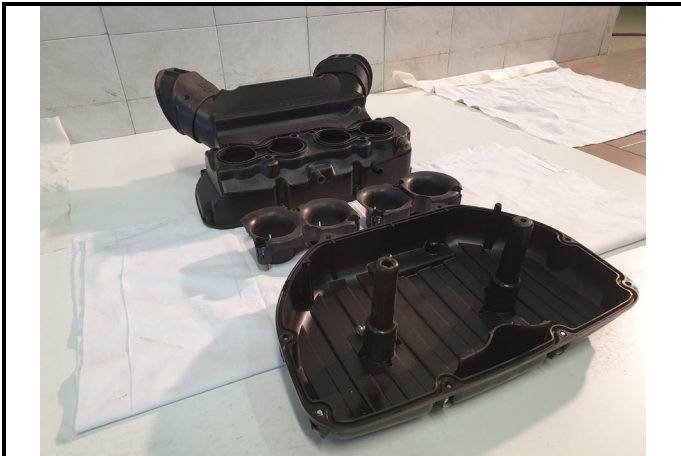
C11-3) Boitier papillon - déposé Throttle unit - dismounted
