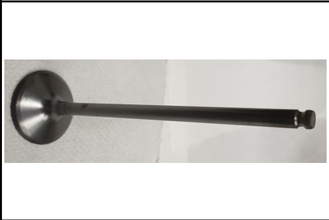
C11-5) Soupape admission - déposée Intake valve - dismantled
