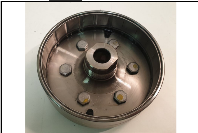
C15-1) Rotor - déposé Rotor - dismounted
