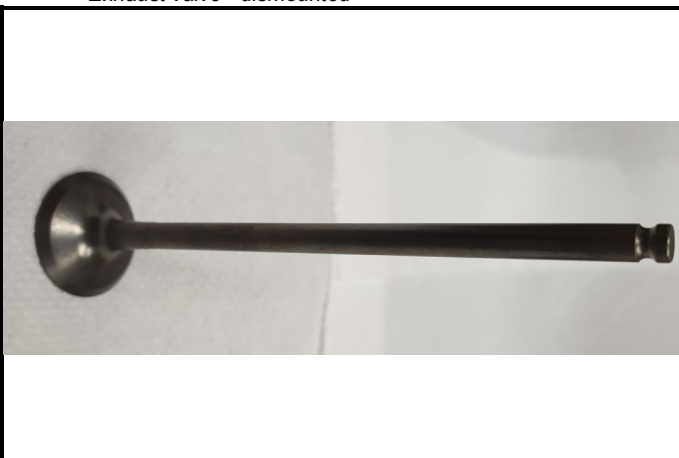
C12-1) Soupape échappement - déposée Exhaust valve - dismantled
