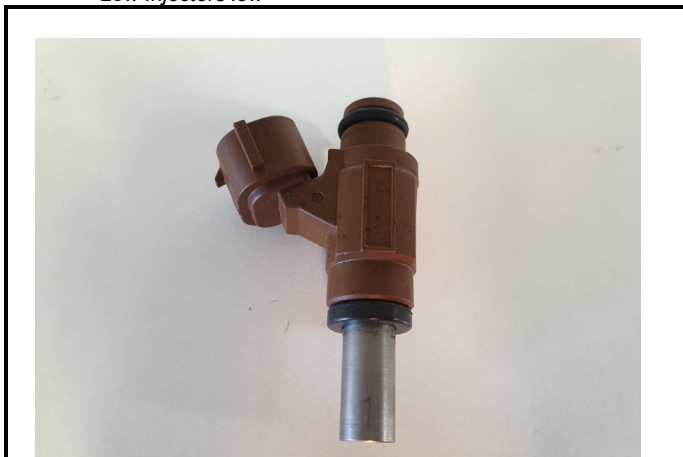
C9-1) Injecteurs bas Low Injectors low
