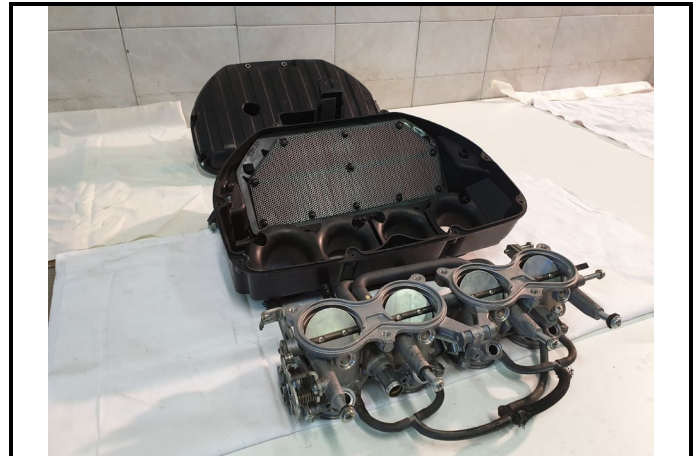
C11-4) Boitier papillon - déposé Throttle unit - dismounted
