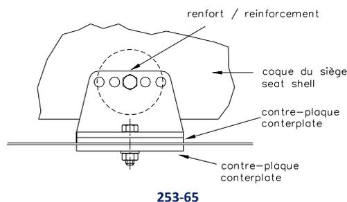
Les fixations sur la coque/châssis doivent comporter au minimum 4 attaches par siège utilisant des boulons de 8 mm minimum de diamètre avec contreplaques conformément au dessin, et être conformes aux indications mentionnées sur la Liste Technique applicable au siège utilisé (cf. "supports à utiliser").
