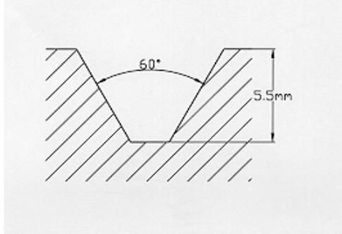
2.5 Dans la zone de contrôle, la surface occupée par des rainures d'au moins 1,8 mm de profondeur, d'une section d'au plus 60° de dépouille (schéma) et 2 mm de largeur, doit occuper au moins 21,5 % de la surface totale.
