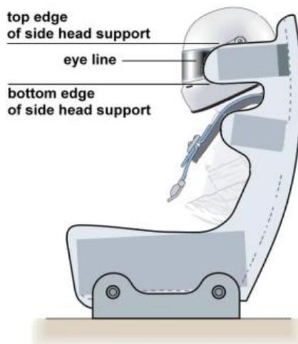
Si un insert en mousse est utilisé entre le pilote et le siège homologué, un support latéral minimum à la tête du pilote, aux épaules et au bassin doit être garanti de la façon suivante :
