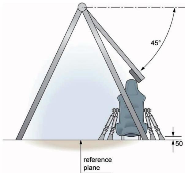
Figure A9 Montage pour l'essai latéral
