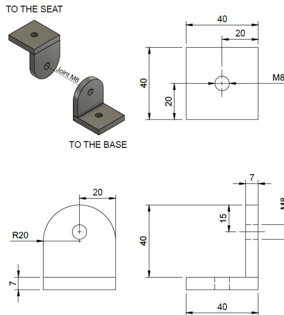
Figure A2 Supports proposés pour les points de montage inférieurs
