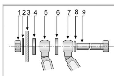
Figure A4 Détail de la fixation de la rotule supérieure au point de montage latéral du siège
