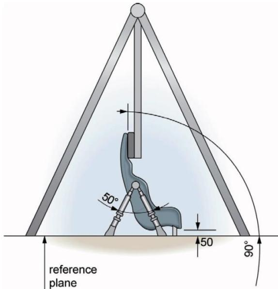
Figure A7 Montage pour l'essai frontal à 90°
