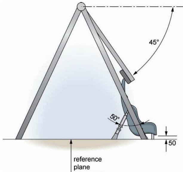
**Figure A8 Montage pour l'essai latéral à 45°**
