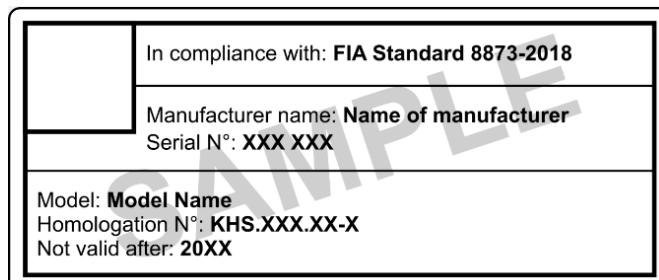
Figure 2. Modèle d'étiquette d'homologation à apposer sur le siège
