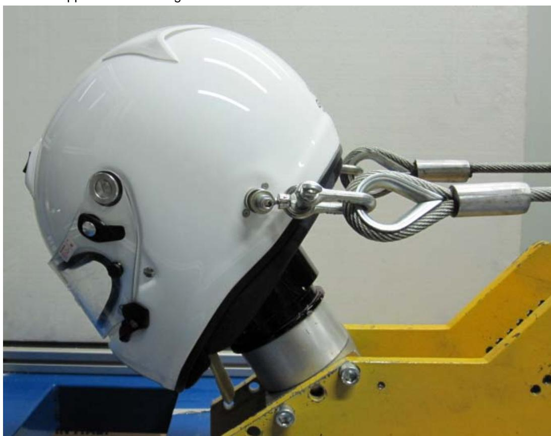
Figure B2. Appareil d'essai des **Fixations de Casque M6** (casque d'essai installé) <sup>(1)</sup>
