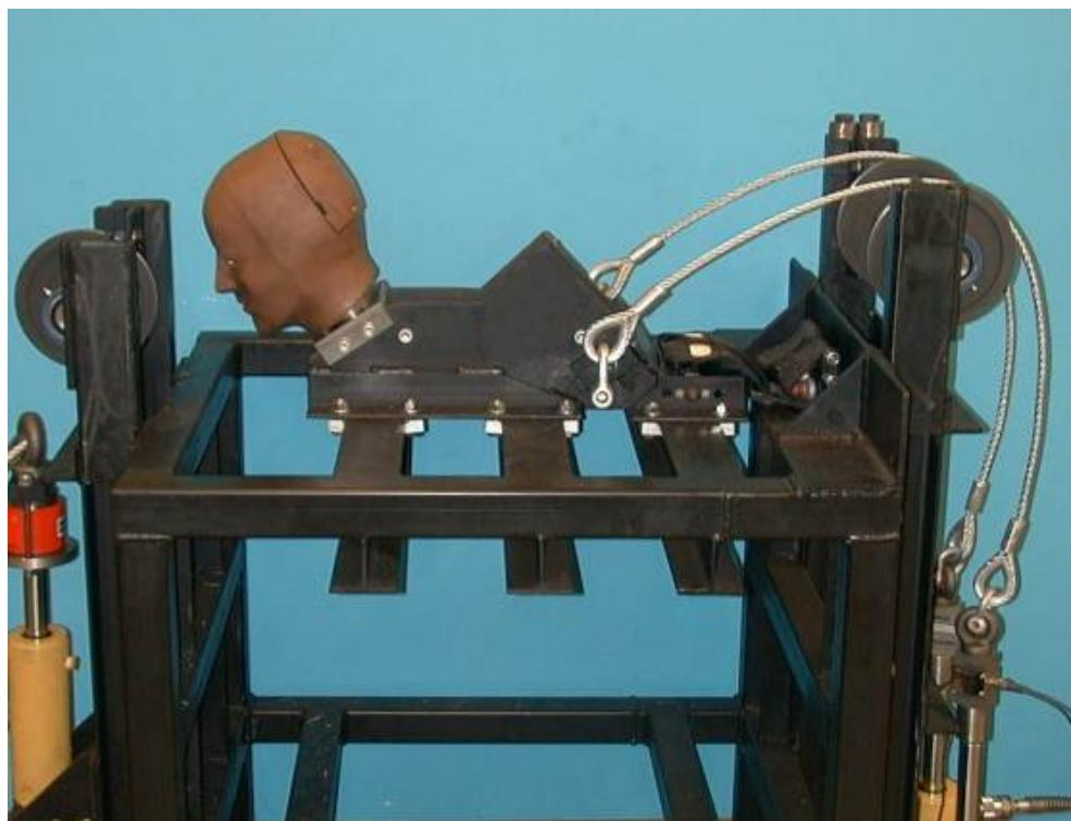
Figure B1. Appareil d'essai des **Fixations de Casque M6**
