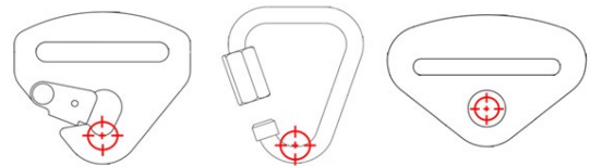
Exemples de points de rotation de l'ancrage de sangle Examples of pivot points of the anchorage of the strap
