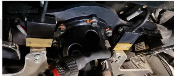
2024 Le système de commande du papillon et la pédale d'accélérateur d'origine sont-ils en place ?
