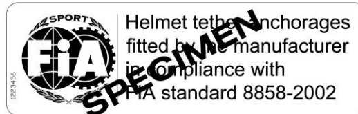
Fig 1 – Etiquette permettant d'identifier les casques équipés dès l'origine des inserts Hans®.
