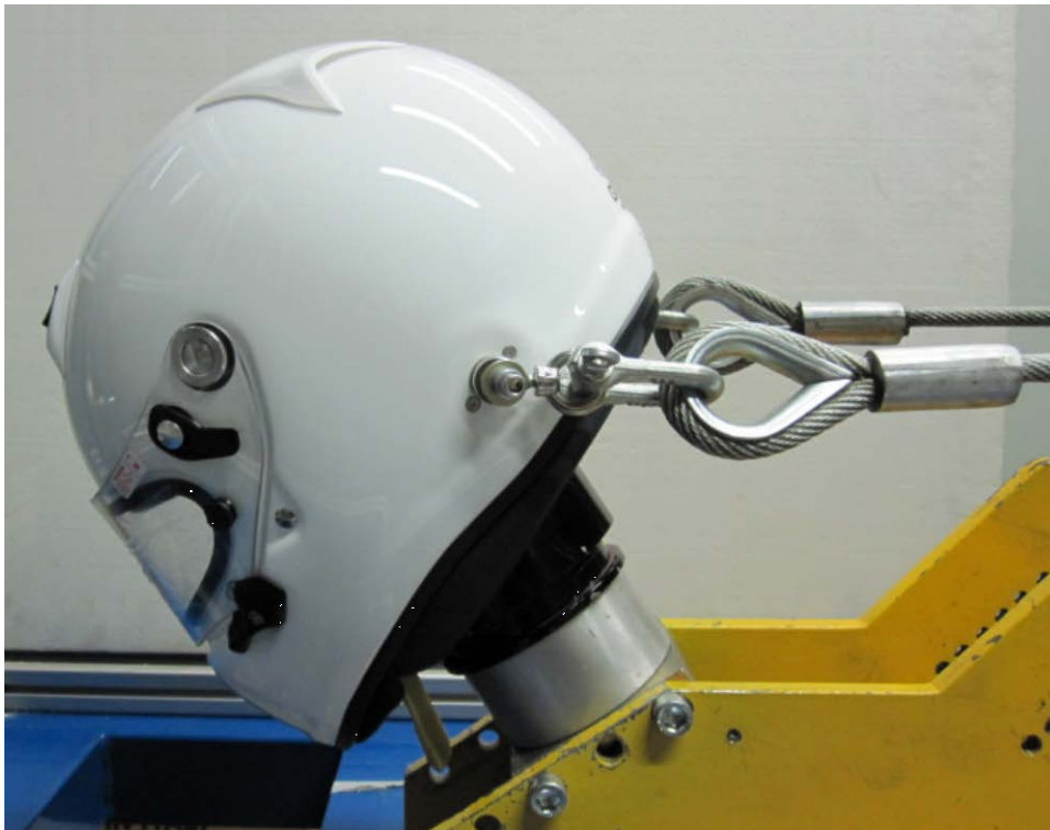
Figure C1. Appareil d'essai des Fixations de Casque M6 Figure C1. Apparatus for testing Helmet-M6-Terminals
