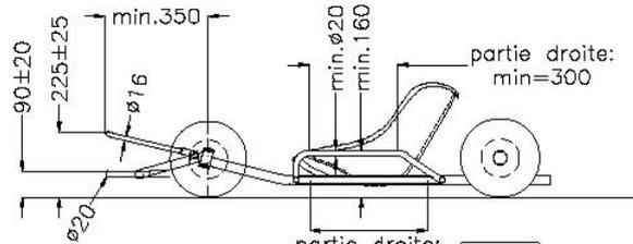
Fixations inférieures horizontales et parallèles à l'axe du châssis
