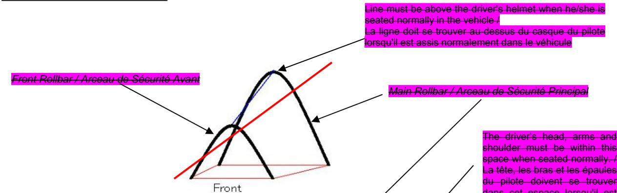
This Line must be above the driver's helmet when seated normally / Cette ligne doit se trouver au-dessus du casque du pilote lorsqu'il est assis normalement.
